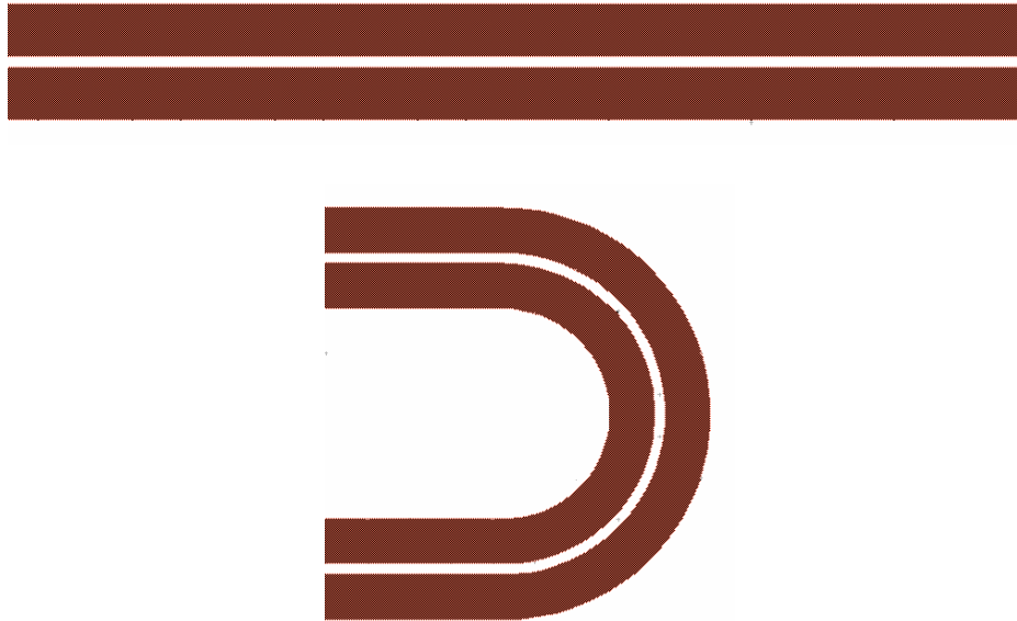
Figura 2.28: Comparación entre acopladores rectilíneos y curvilíneos
