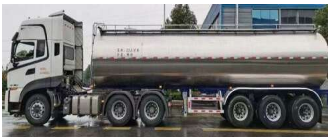
Figura 13. Camión cisterna isotérmico compartimentado de acero inoxidable para el transporte de leche cruda [61]
