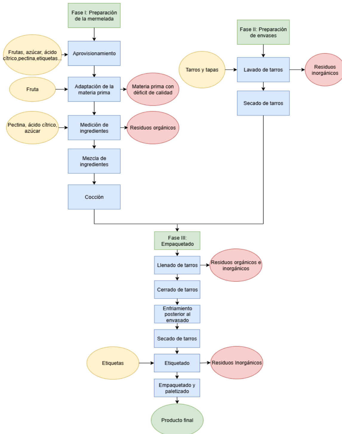
Figura 8.- Proceso productivo de la planta esquemático.
