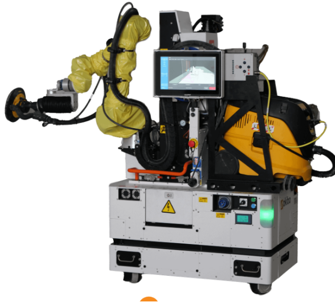
Figura 1.3 Robot para acabado de paredes de OKIBO (Imagen extraída de la referencia[8]).
