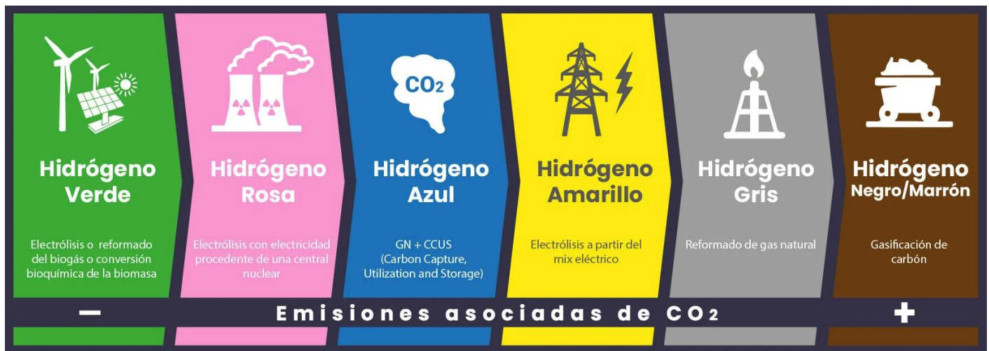
Figura 7: Tipos de hidrógeno según el proceso de obtención y las emisiones de CO 2 asociadas. ((MITERD), 2020)
