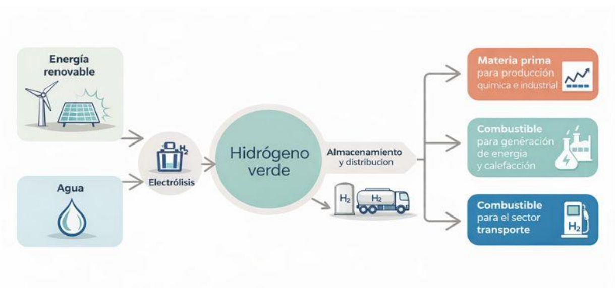
Figura 6: Proceso de producción, almacenamiento y aplicaciones del hidrógeno verde. ((MITERD), 2020)
