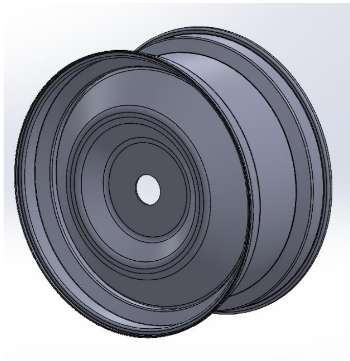
Figura 3-71: Boceto llanta completa sin aligerar
