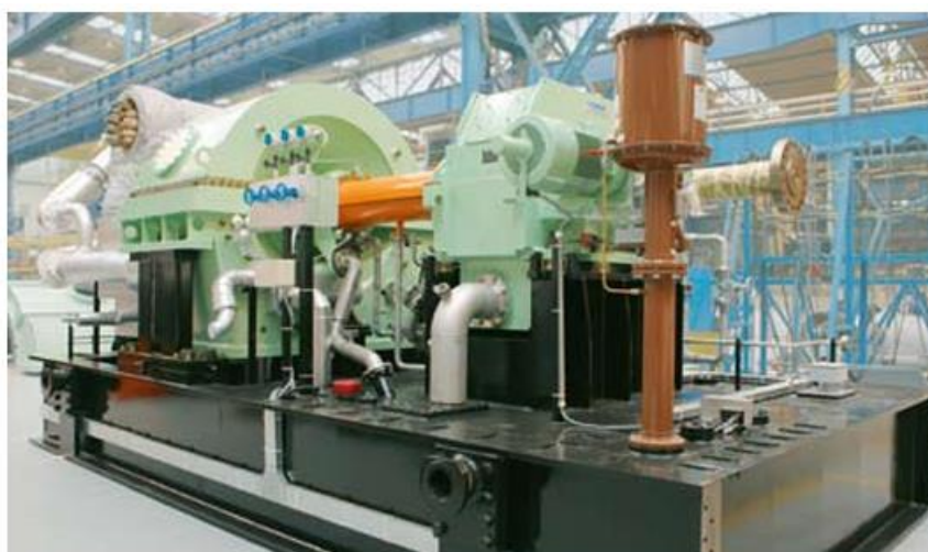
Figura 5.6. Turbina de Vapor SST-300 [11].
