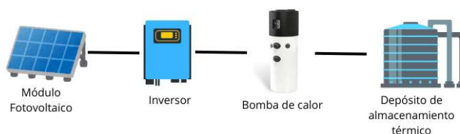
Figura 3-2: FV y bomba de calor
