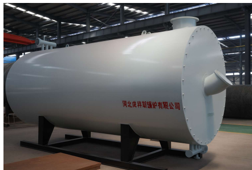
Figura 3-7: Almacenamiento térmico. Aceites térmicos
