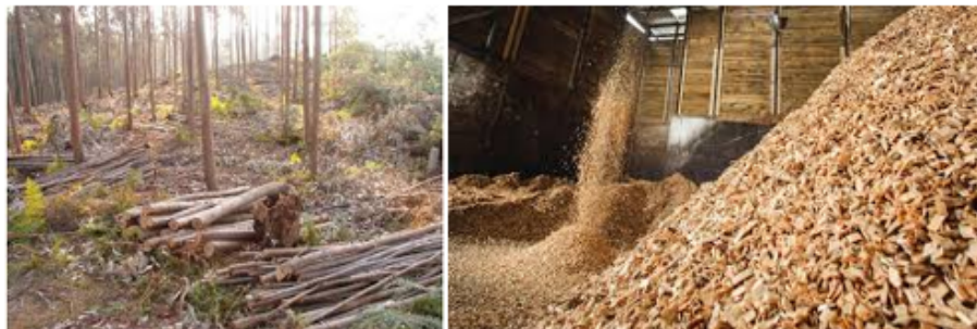
Figura 2.14 Tipos de Biomasa Residual: madera residuo forestal (izquierda) y madera residuo industrial (derecha).
