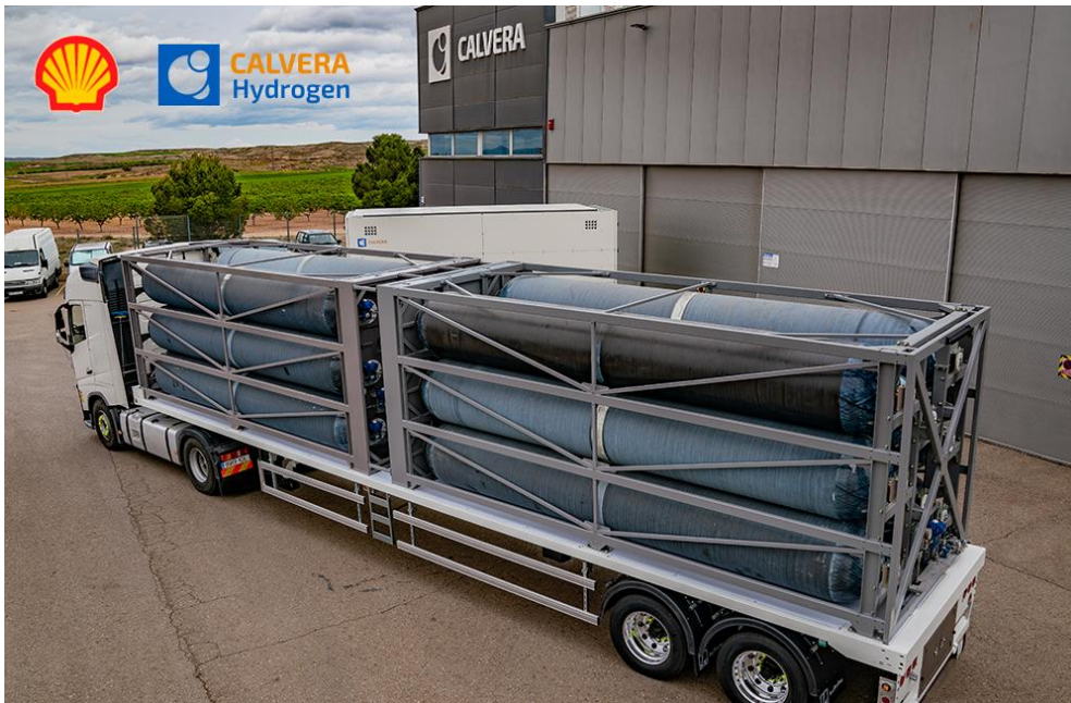
Figura 17: "Tube trailer" para transporte de hidrógeno comprimido. [24]
