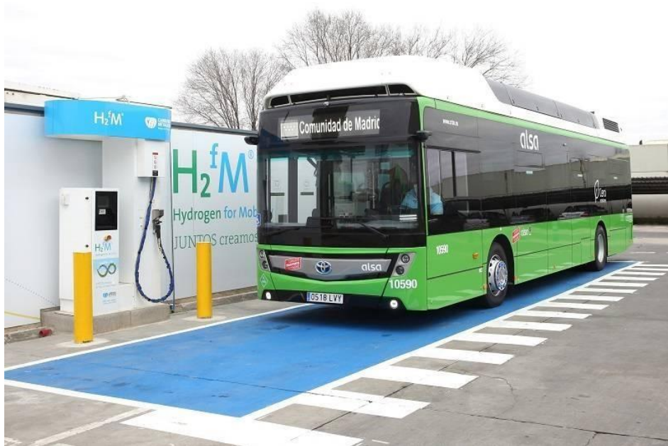
Figura 6: Estación de repostaje de hidrógeno para autobuses en Madrid, España. [14]
