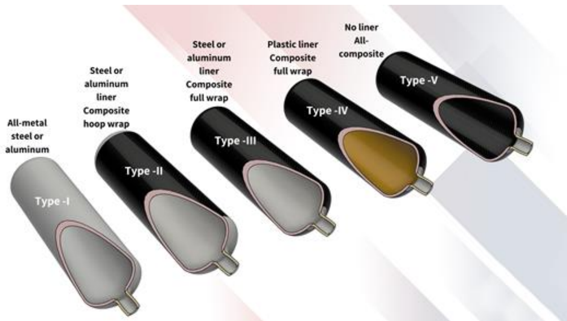
Figura 12: Tanques tipo I, II, III, IV y V de almacenamiento de hidrógeno gaseoso. [20]
