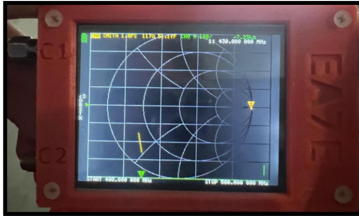
Ilustración 146. Comprobación circuito abierto
