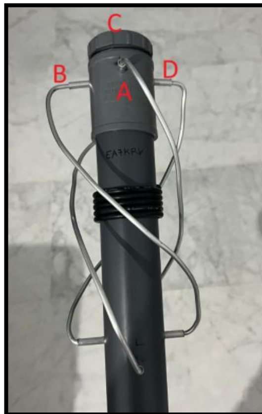
Ilustración 58. Colocación de las varillas formando media vuelta
