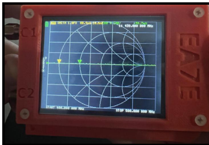
Ilustración 147. Comprobación circuito cerrado.
