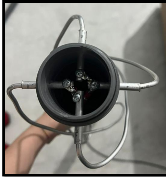
Ilustración 59. Resultado del conexionado final tras soldar.
