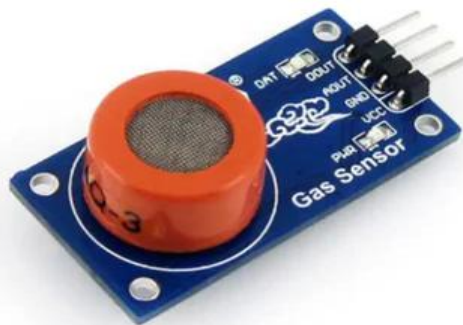
Figura 4. Parte frontal del sensor MQ-3
