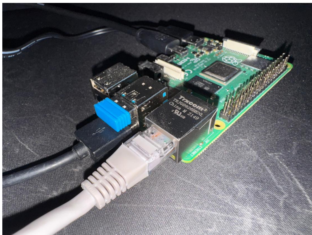
Figura 14. Configuración básica - Ratón, teclado y RJ45
