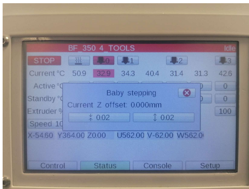
Figura 2.16 Ajuste del baby stepping en la pantalla de la impresora.
