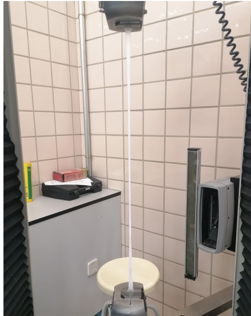
Figura 3.5 Probeta completamente estirada en la máquina.
