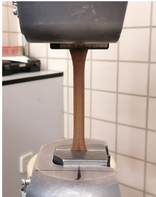
Figura 3.1 Probeta colocada en las mordazas.
