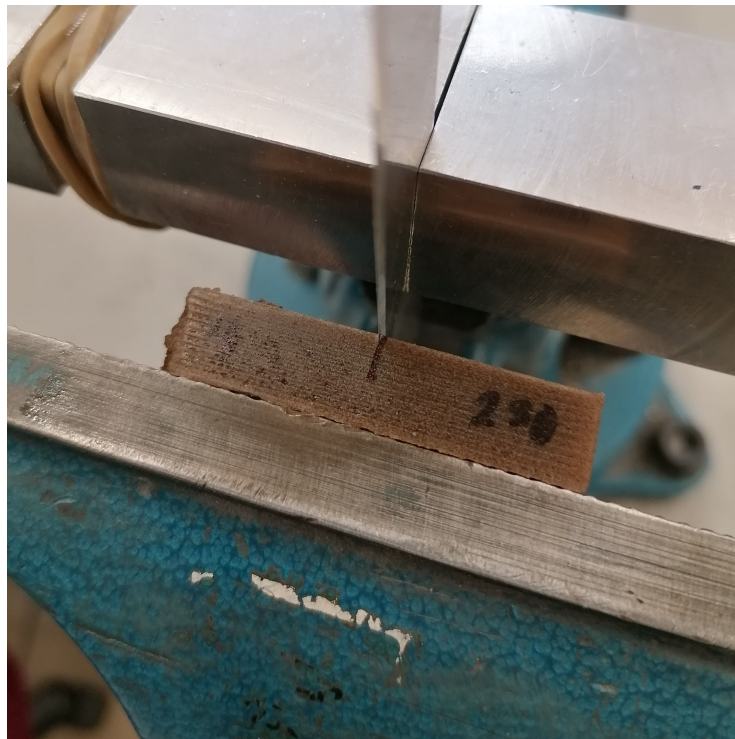
Figura 3.6 Cuchilla apoyada sobre una probeta en la fase de generación de grieta.
