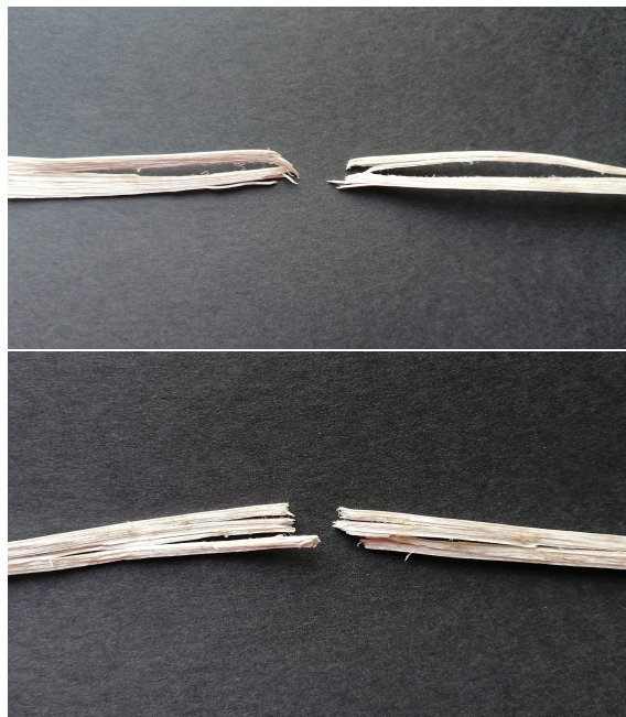
Figura 4.9 Fracturas de las probetas que se rompieron una vez terminado el ensayo.
