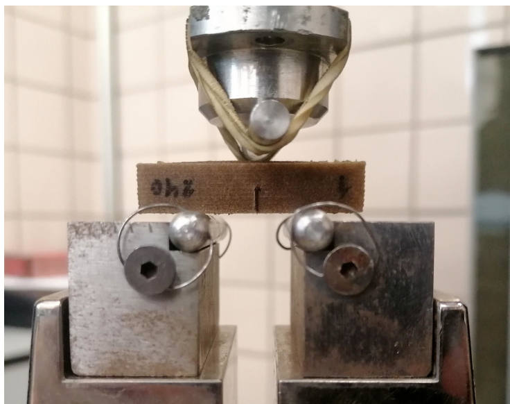
Figura 3.8 Colocación de la probeta en el ensayo de fractura.
