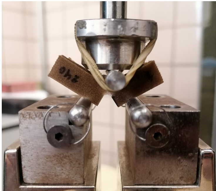
Figura 3.9 Estado de la probeta tras completar el ensayo.
