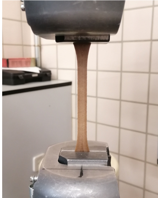
Figura 3.3 Estado de la probeta al retirar el extensómetro.
