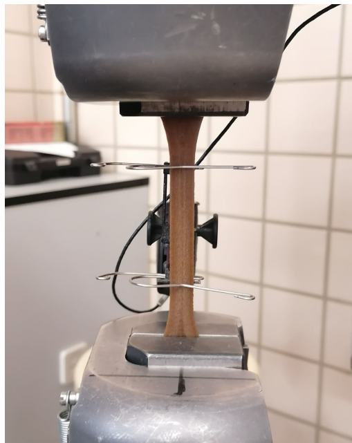
Figura 3.2 Colocación del extensómetro en la probeta.
