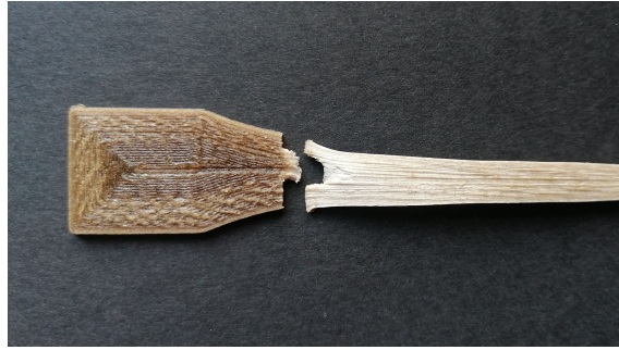
Figura 4.8 Fractura de una probeta que se rompió durante el ensayo.
