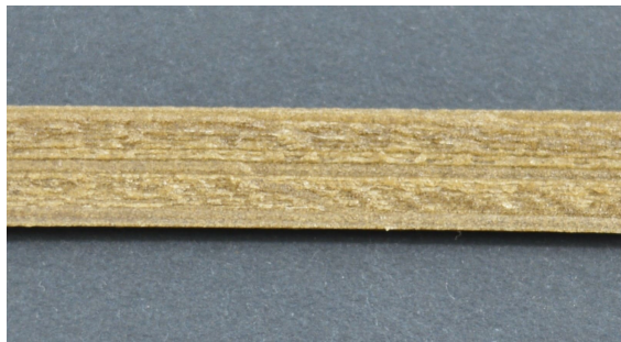
Figura 4.1 Detalle de la sección central de una probeta de tracción.
