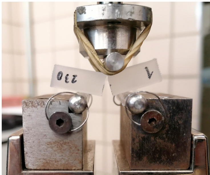
Figura 3.10 Imagen de una de las dos probetas rotas durante el ensayo.
