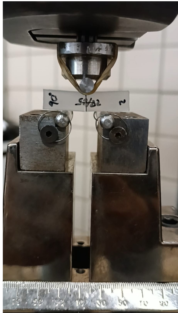
Figura 7.6 Probeta en posición antes de comenzar el ensayo.
