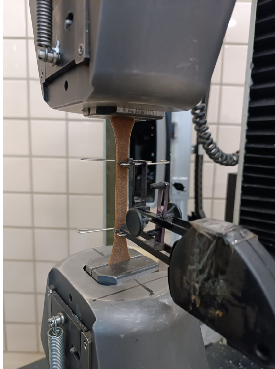
Figura 7.2 Probeta colocada en la máquina de ensayos antes de empezar a introducir cargas.
