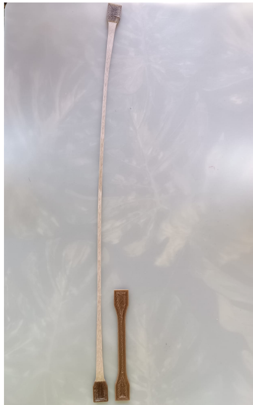
Figura 8.8 Comparación de la longitud de una probeta antes y después del ensayo.
