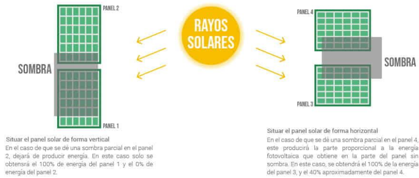
Figura 13. Impacto de la sombra en paneles solares. [15]
