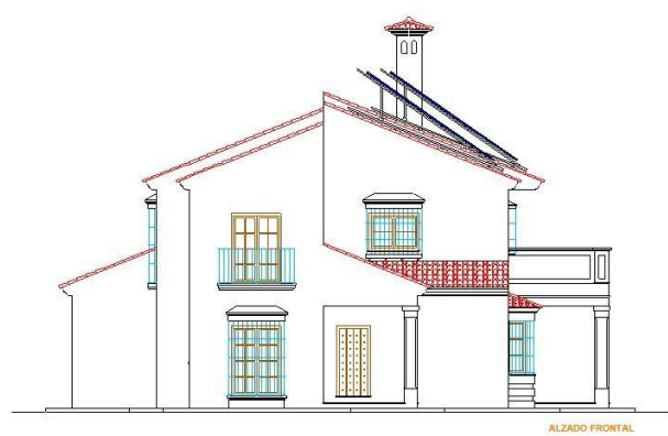
Figura 15. Alzado frontal con placas instaladas
