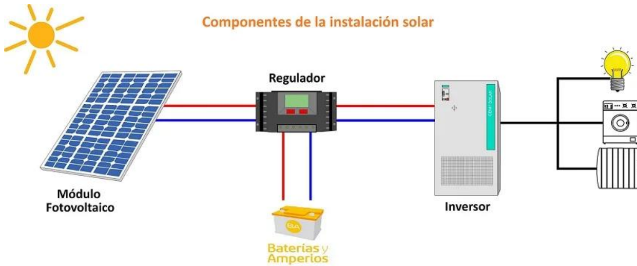
Figura 2. Sistema de almacenamiento de energía en baterías. [41]
