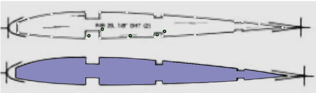
Figura 36 – Modelo bruto de la costilla 20 de las alas del Kawasaki Ki-45 Nick
