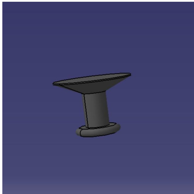
Figura 49 – Remache usado en las uniones revestimiento-costilla en el ala del Kawasaki Ki-45 Nick Tras arreglar el problema existente con las costillas, se pasó al modelado de los largueros, larguerillos y borde de ataque. Para ello, se siguió el mismo procedimiento que el que se siguió en el modelado de los largueros del fuselaje. Para no sobrecargar el estudio, simplemente se mostrará el resultado del ala con el conjunto de la estructura modelada (Figura 50).
