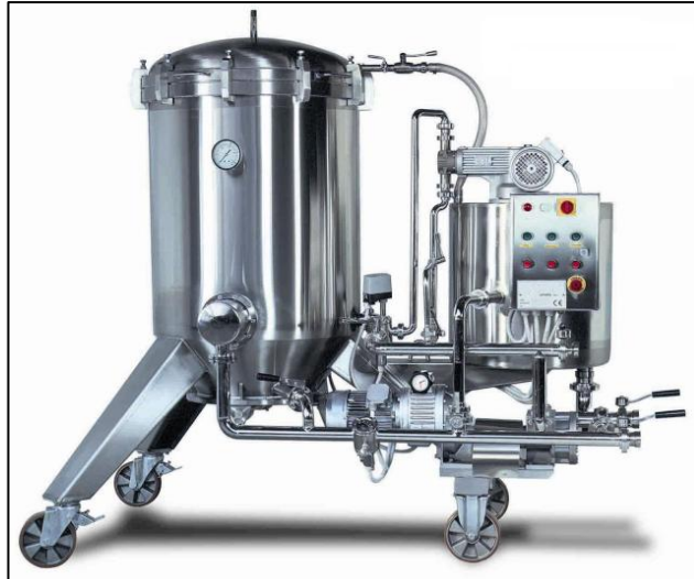
Figura 4-12. Tanque de dosificación de tierras diatomeas y filtro de placas
