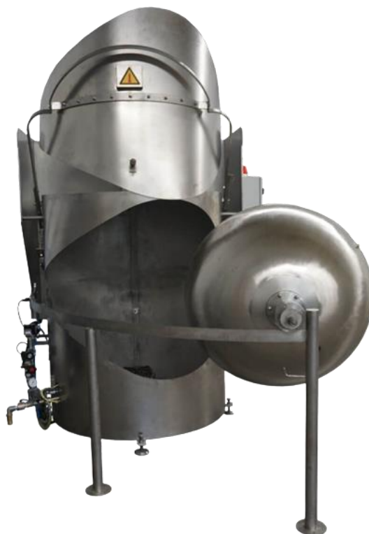
Figura 5-6. Tostador de frutos secos con tambor rotativo extraído[21].
