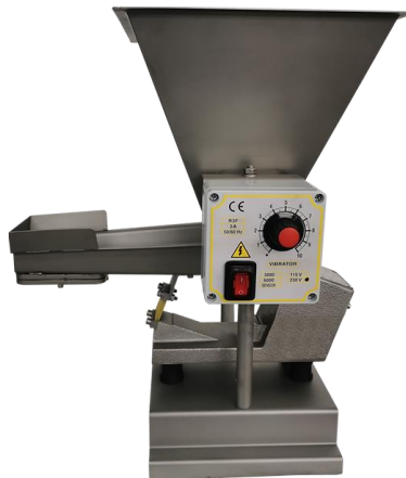
Figura 5-12. Dosificadora electromagnética para dosificar azúcar glas y ajonjolí[23].
