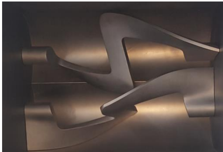
Figura 5-10. Doble brazo helicoidal tipo Z[23].
