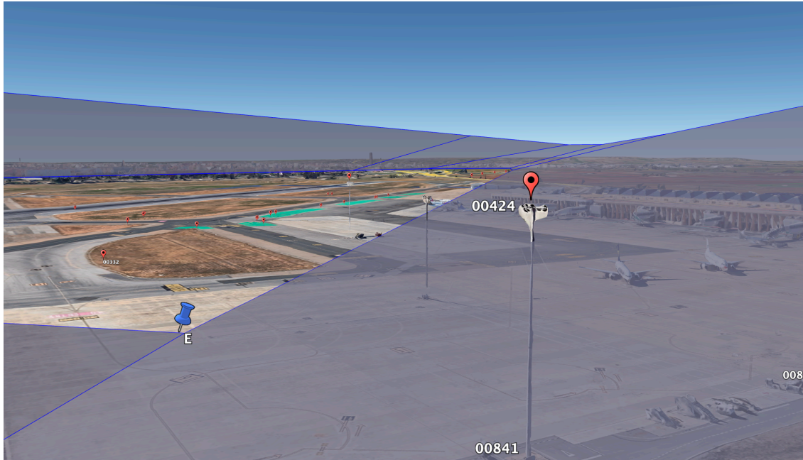
Figura 4.6: Obstáculos que penetran las OAS para la aproximación por RWY09.
