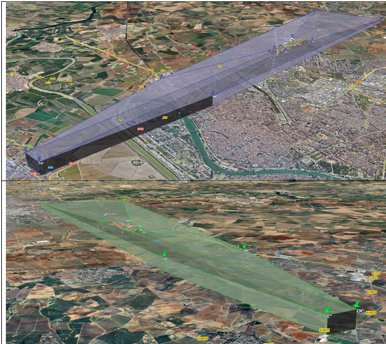
Figura 4.4: OAS para las RWY09 (arriba) y RWY27 (abajo).
