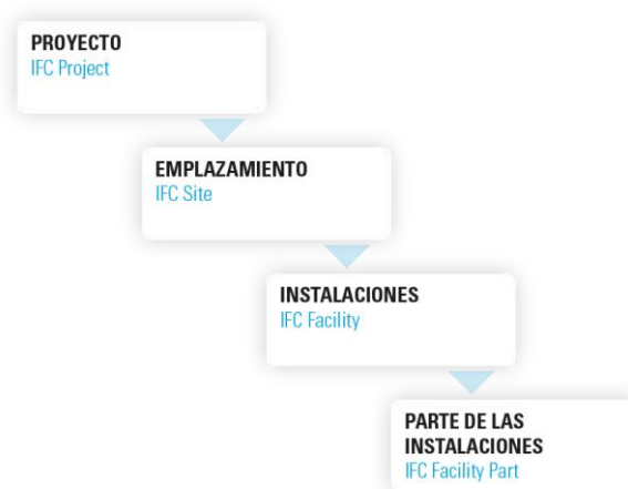
Figura 17 - Descomposición espacial de un proyecto en IFC (Fuente: Elaboración Propia)
