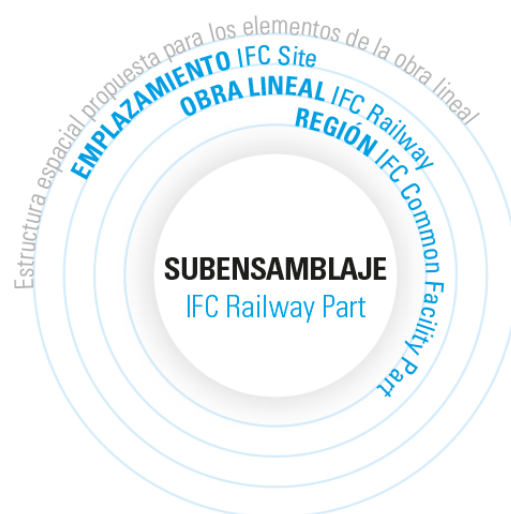
Figura 147 – Estructura espacial propuesta para los elementos de la Obra Lineal (Fuente: Elaboración Propia)
