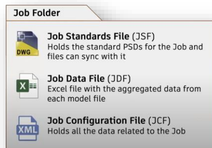
Figura 110 – Estructura de un Trabajo (Fuente: Autodesk)
